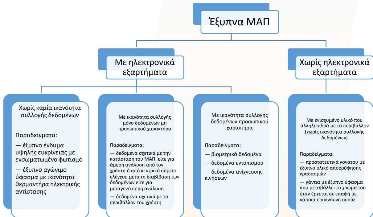
Σχήμα 1 Πρόταση για ένα σύστημα ταξινόμησης των διάφορων τύπων έξυπνων ΜΑΠ με βάση τη σύνθεσή τους και τις ικανότητες συλλογής δεδομένων
